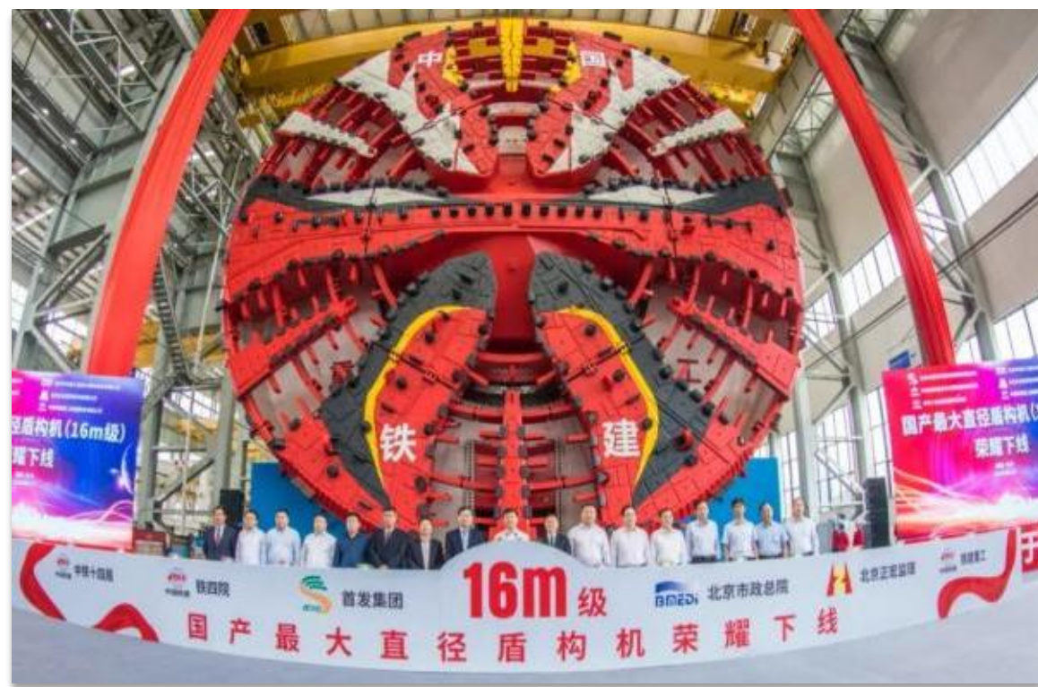
國產最大直徑盾構機「京華號」- 隧道挖掘的「大國重器」
